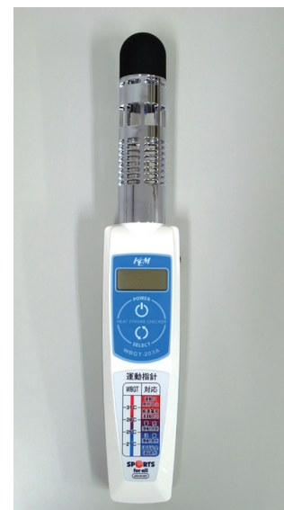
図2 WBGT測定計 (例示：ミズノ社製WBGT-203A)
