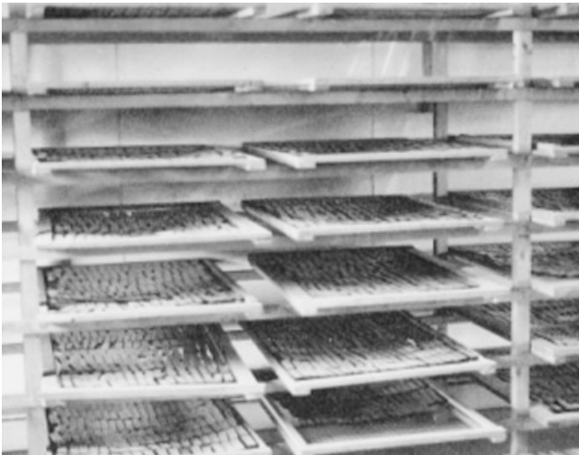
【図7】棚に移してさらに自然乾燥
